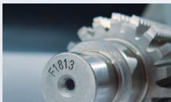
Marcatura laser di creatori (utensile a dentare).
