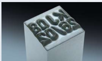
Incisione 2,5D di un numeratore con angolo di sforno predefinito.
