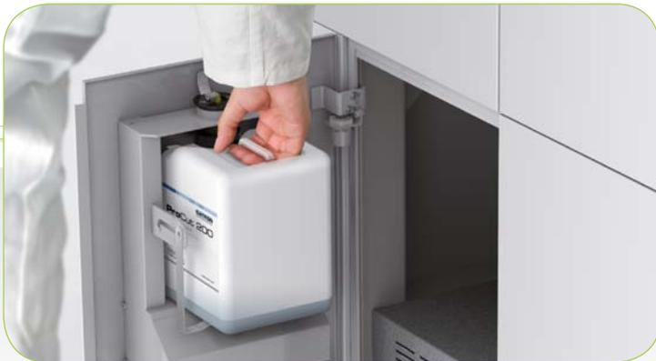
Risultati ottimali nella lavorazione dei metalli (CoCr e Titanio) sono ottenuti grazie alla lubrorefrigerazione minimale. La sostituzione del contenitore del liquido utilizzato avviene facilmente grazie al sistema di cambio rapido. Il livello del liquido viene controllato elettronicamente e indicato sull'iPad Apple.
