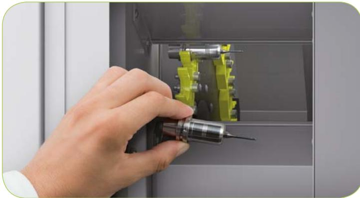
Il cambio utensili automatico a 13 posizioni integrato è particolarmente facile e sicuro da utilizzare. La più elevata affidabilità di processo si raggiunge grazie alla misura della lunghezza utensili e al controllo della loro rottura.
